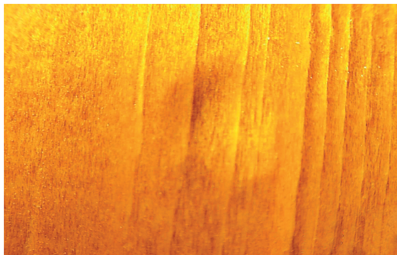
Trvalo pružný lazúrovací film Cetol WF 950/955 po údere ľadovým krúpom - viditeľne viac ochrany pre namáhané drevené konštrukčné prvky. Film je nepoškodený na základe technológie PowerFeed.
